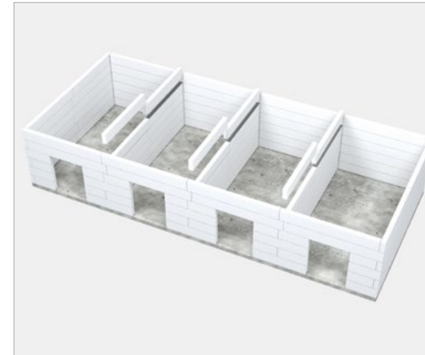
5. Vollständige Gebäudehülle im BosT-System
