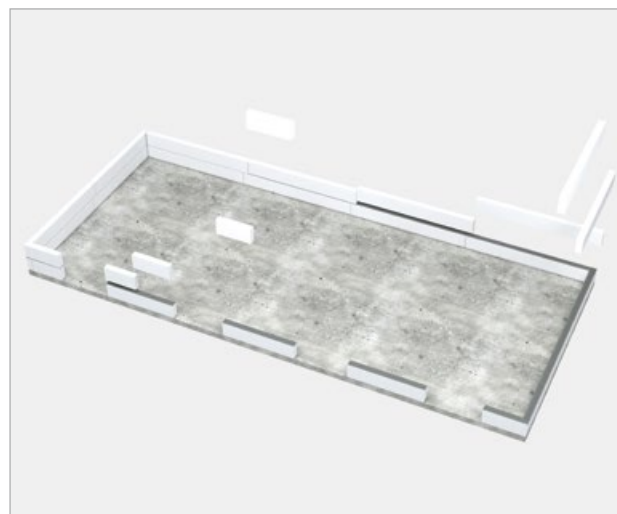
3. Montage ab der zweiten Lage in Dünnbettmörtel
