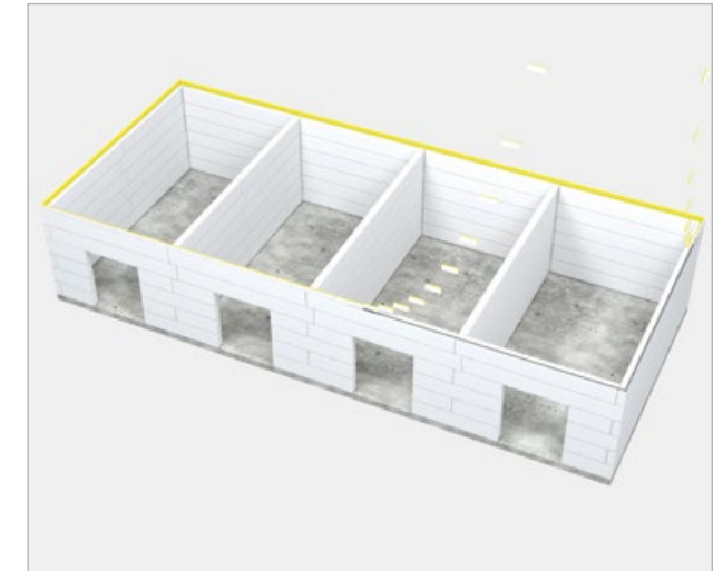
6. Setzen des Deckenabstellsteins
